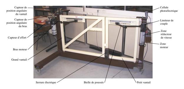
Les deux vantaux du portail sont mis en mouvement par des motorisations identiques. Chaque dispositif est constitué :
